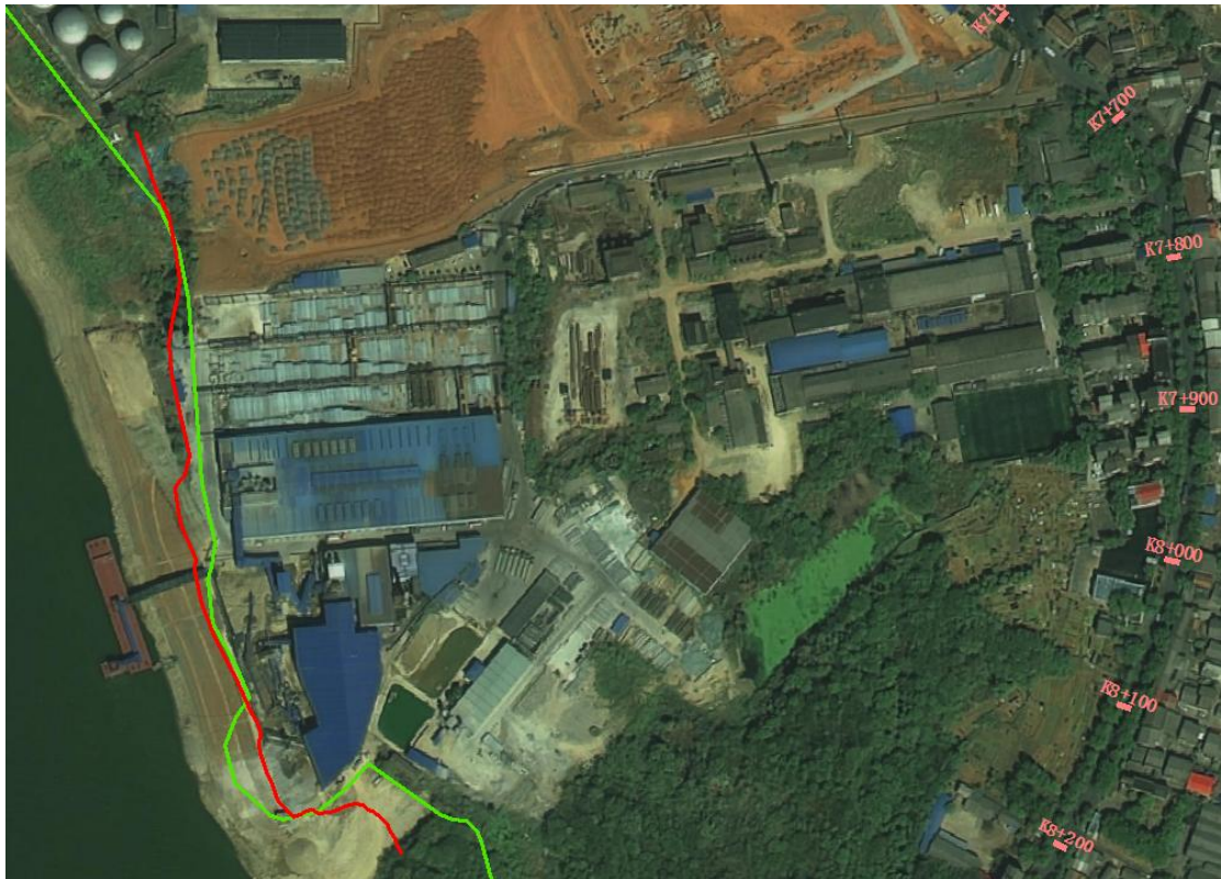
图13 无堤防段划界示意图
